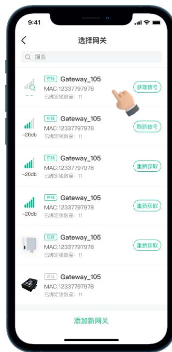
04.选择网关（高速率433通讯模块在门锁绑定网关时可搜索测试网关与门锁之间的信号强度，选择信号最好的网关做绑定）
