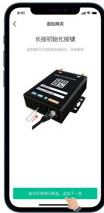
05. 长按网关初始化按键，网关进入初始化状态，指示灯闪烁，点击下一步
